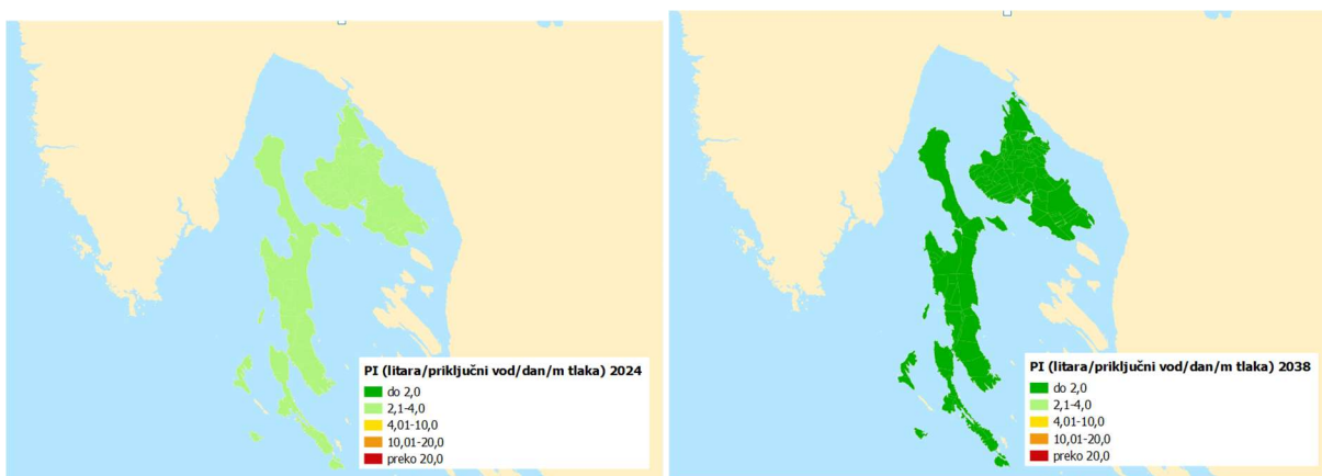
Slika 42: Jedinična vrijednost Stvarnih gubitaka danas (slika lijevo) te nakon provedbe mjera 2038. u l/priključni vod/dan/m (slika desno) na razini uslužnog područja
